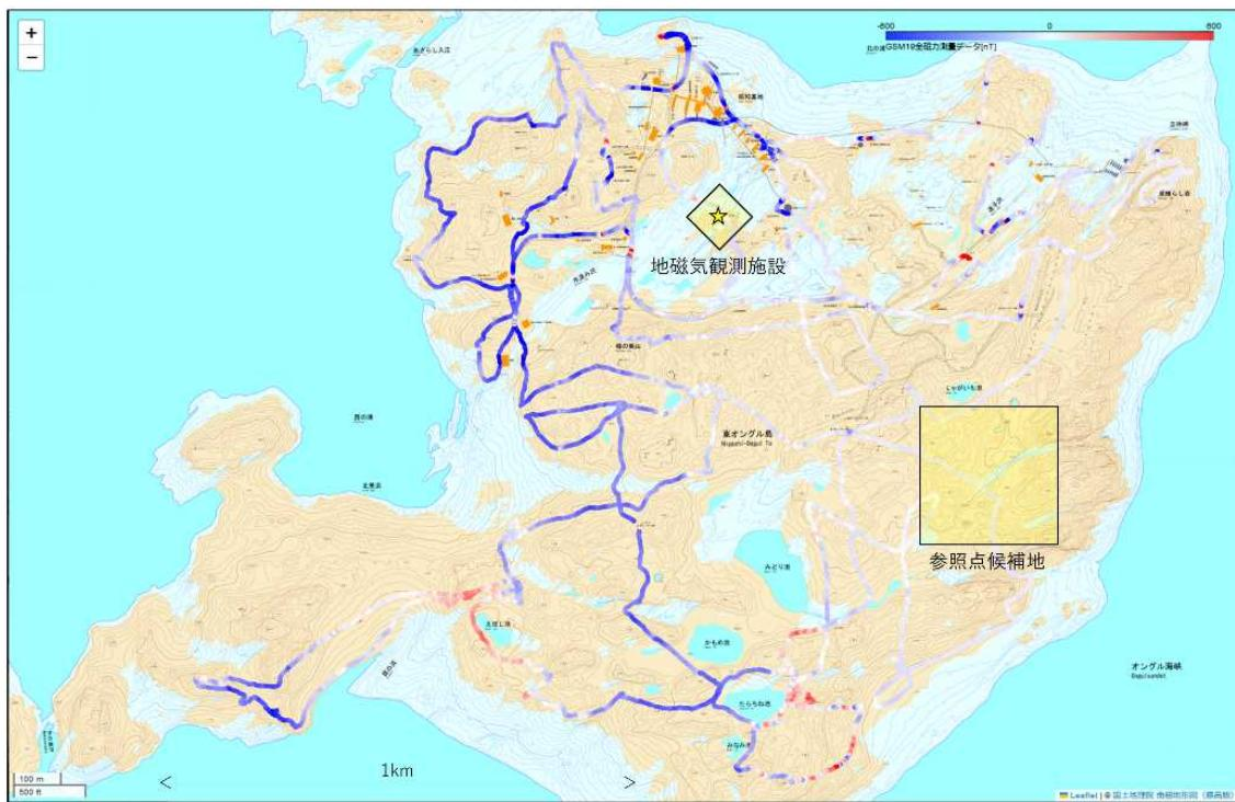
図2 徒歩での全磁力磁気測量結果（東オングル島全体）
