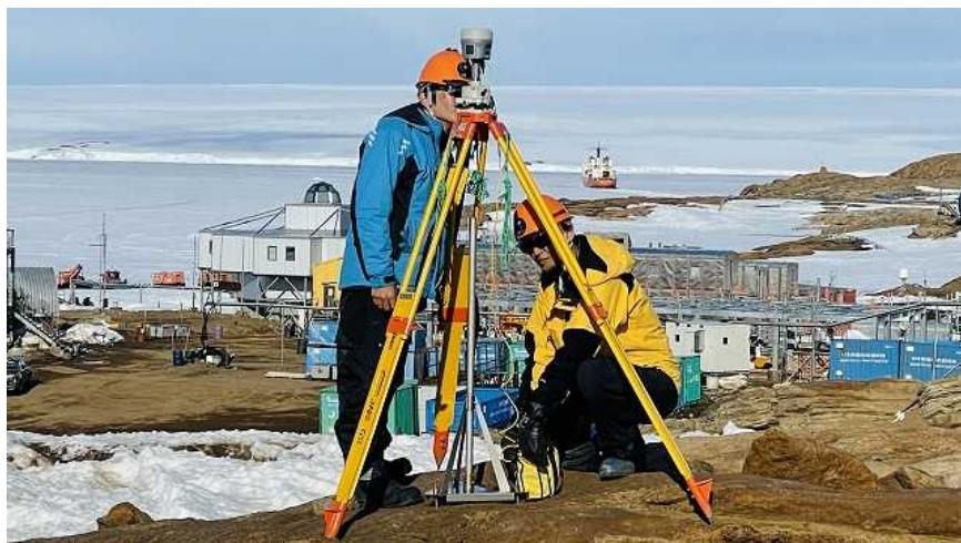
図 11 精密測位のための GNSS アンテナの設置（協力：国土地理院）
