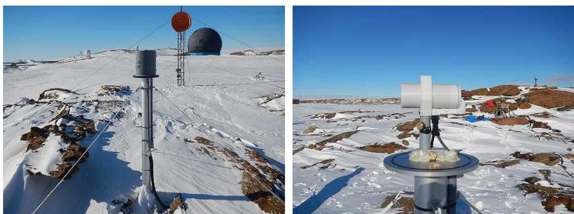
図 9 オーバーハウザー磁力計のアルミ製センサポールと塩化ビニール製センサカバー (左)、センサカバーを取り外した状態 (右)
