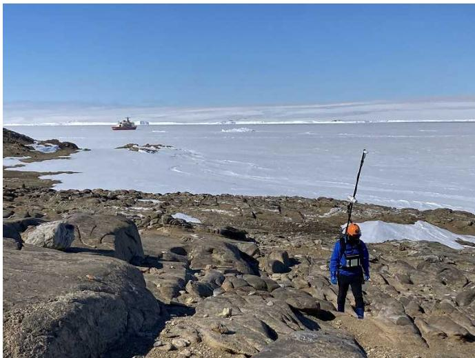
図1 徒歩での全磁力磁気測量
